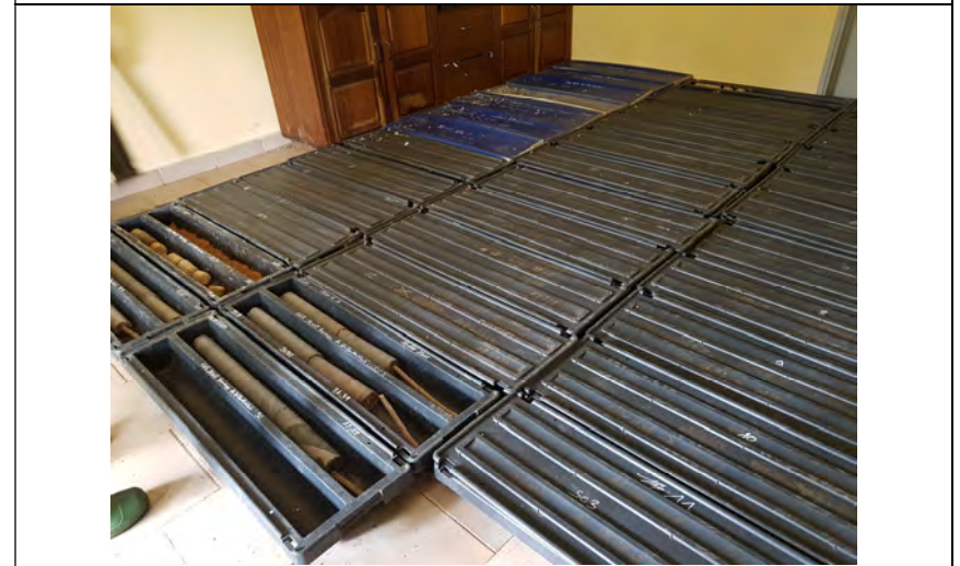
3.8 Carottes prélevées lors des forages géotechniques, conservées dans la carotterie de Mandji.
