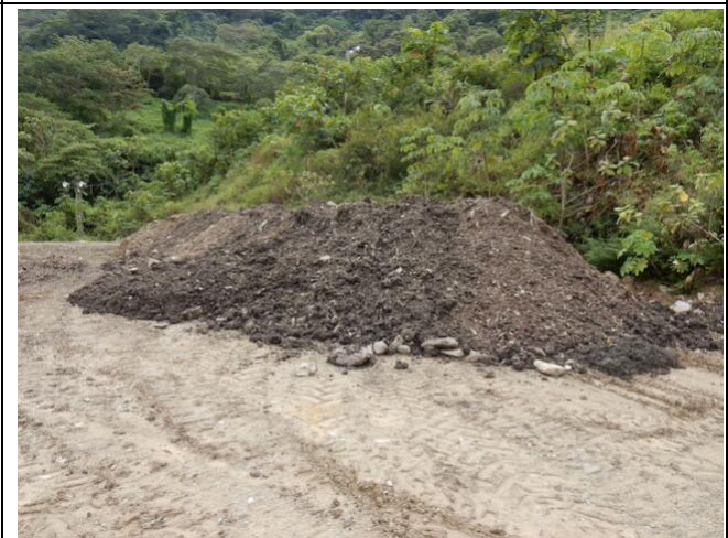
Foto 30: Lodo seco para enriquecimiento de suelos de PTAR Medellín
